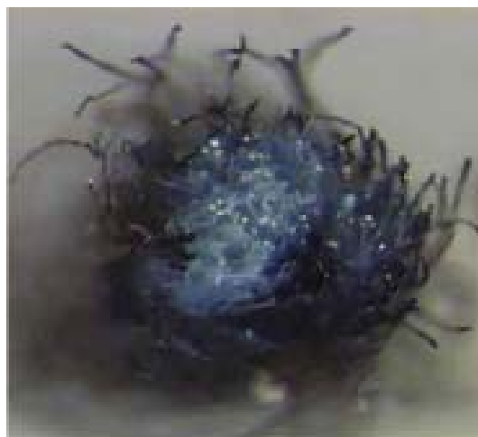
Esempio di sezione di filato tinto con indaco estratto da tessuto denim
